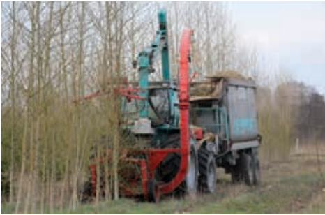
Abb. 5: Anbau-Mähthacker bei der ersten Pappel-ernte nach 7 Standjahren
